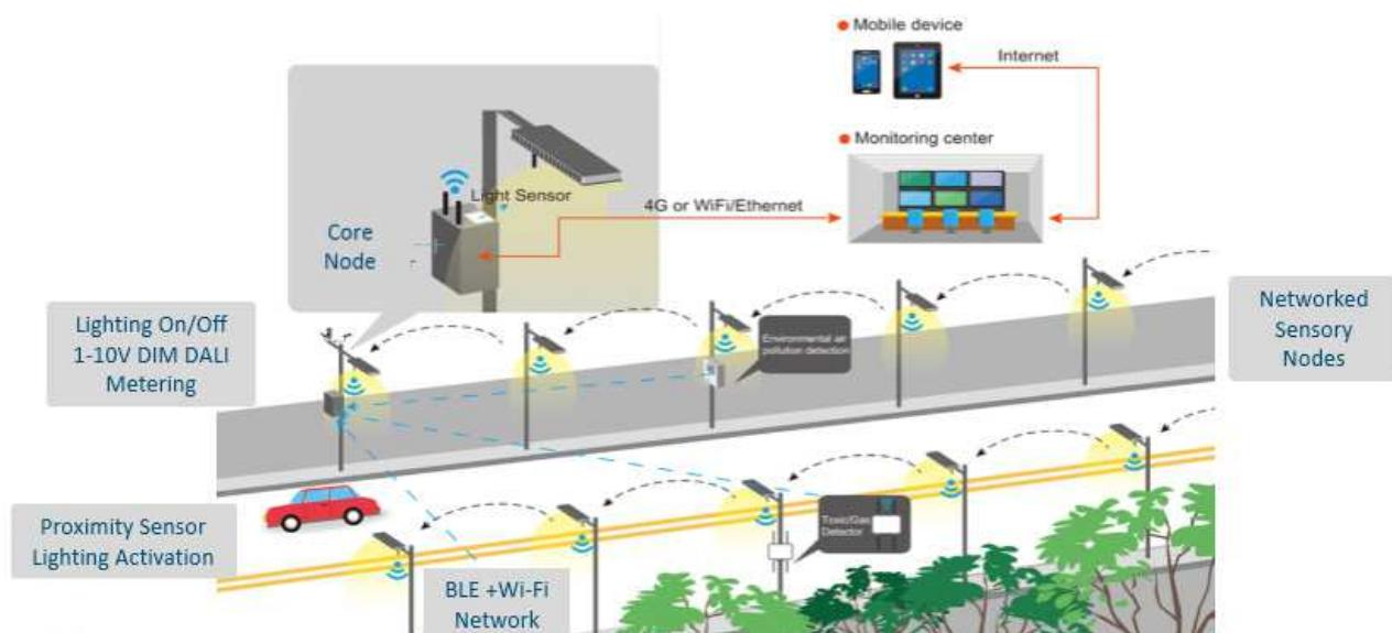
Obrázek č. 5: Příklad činností Inteligentního pouličního osvětlení
